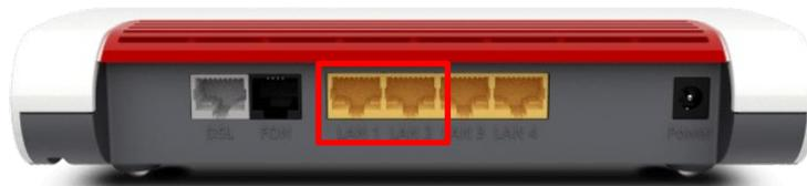
**Modell 7590 AX (v2):** Stecken Sie das mitgelieferte Netzwerkkabel in die Buchse **WAN** der FRITZ!Box und in den linken LAN-Port Ihres Netzabschlussgeräts (NAG/ONT). Verbinden Sie die FRITZ!Box mit einem weiteren Netzwerkkabel via Buchse **LAN1** mit der Netzwerkschnittstelle Ihres PCs/per WLAN.
